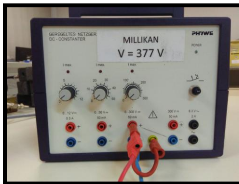
Figura 4: Fotografia dos terminais para polarizar a fonte.
